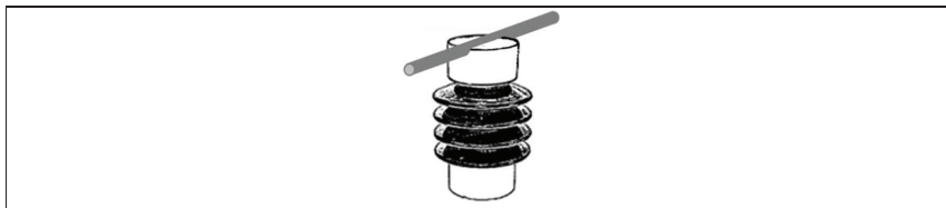
Figuur 5.18. Plaatsingswijzen van elektrische leidingen — Op isolatoren
