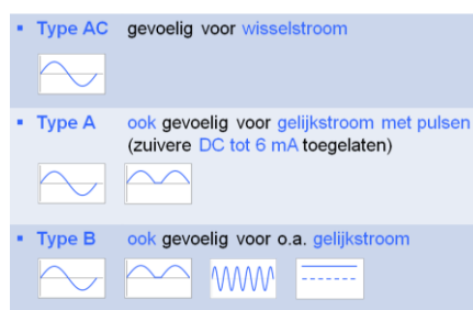
Figuur 6: enkele types diff. en de soorten foutstroom waarvoor ze bedoeld zijn
